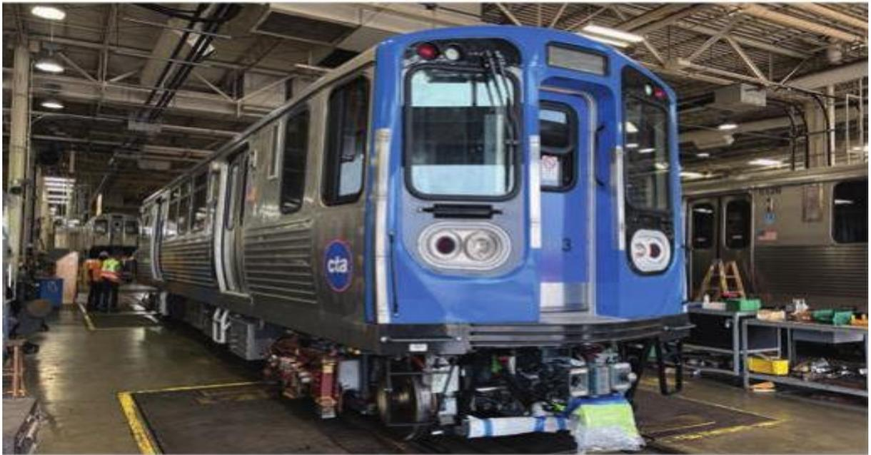
Усовершенствована система подвески не только придает поезду плавность хода, но и открывает возможность его эксплуатации на разных линиях с отличающейся высотой платформ благодаря ультразвуковым датчикам, позволяющим определять высоту платформы и автоматически подстраивать под нее высоту пола.
