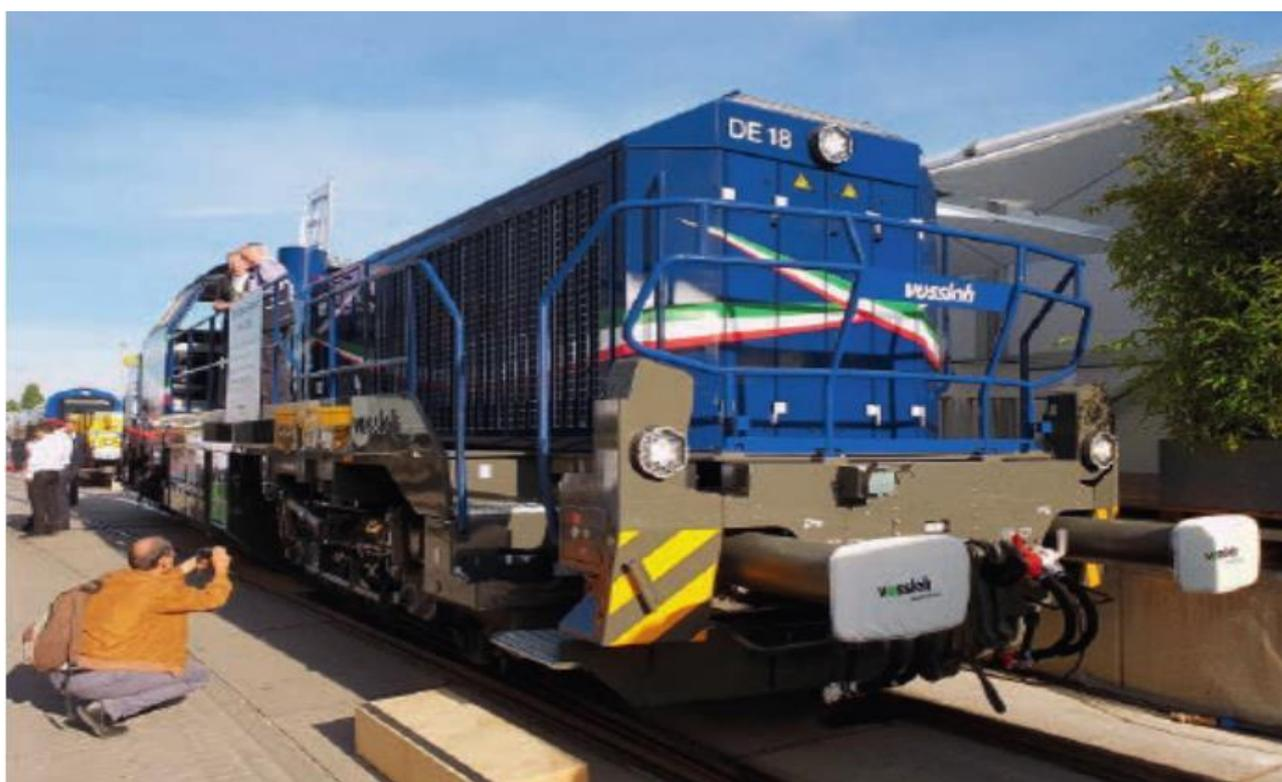
Локомотив DE 18 SmartHybrid оборудован дизельным двигателем MTU 12V 4000 мощностью 1,8 МВт, соответствующим европейским экологическим нормам уровня V.
