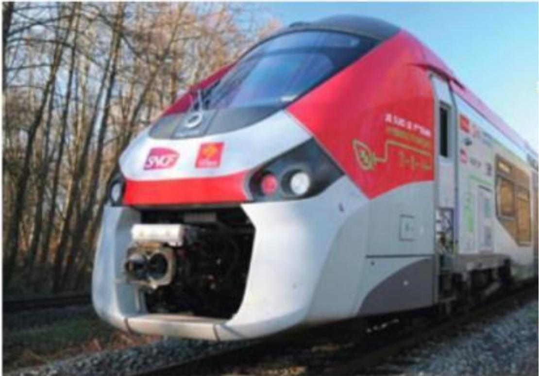
Поезд Règiolis производства компании Alstom с гибридным тяговым приводом с питанием от контактной сети, дизеля и тяговых аккумуляторов для SNCF
