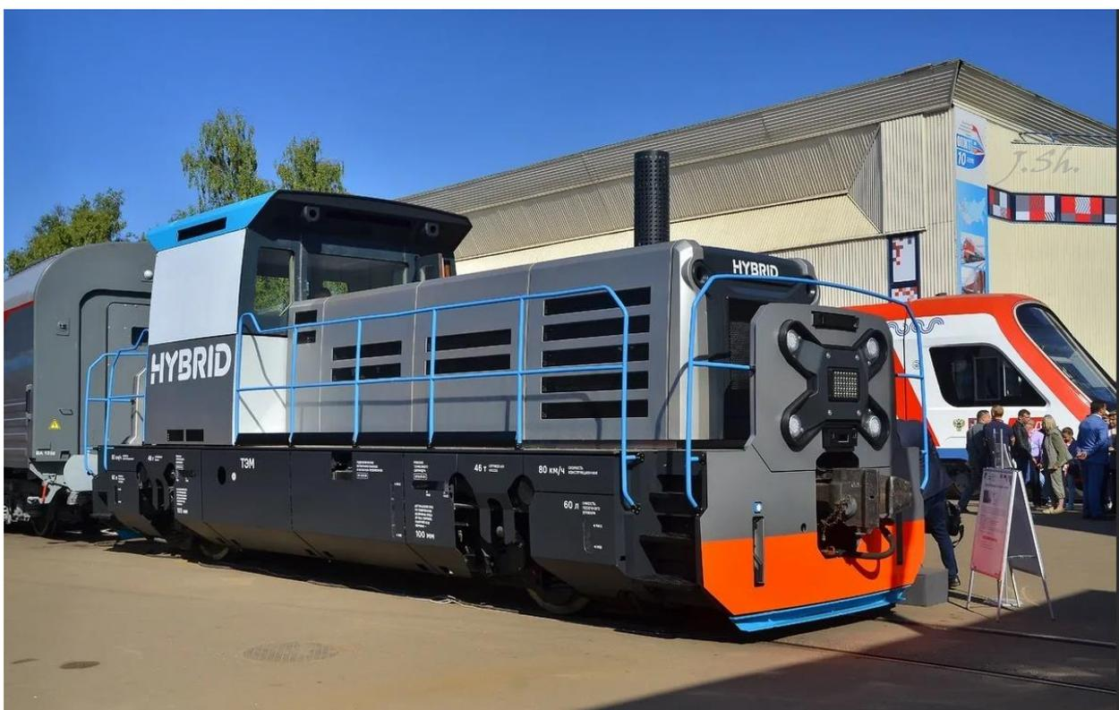
Маневровый локомотив Hybrid-Shunter 1000 производства компании CZ LOKO с тяговыми аккумуляторными батареями
