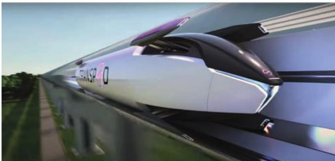
Для тяги капсулы используется линейный двигатель с активной системой управления в реальном времени, которая получает в том числе данные от датчиков, сканирующих пространство перед капсулой. Для уменьшения аэродинамического сопротивления предусмотрен отвод воздуха при движении капсулы через специальные воздуховоды, проходящие по всей ее длине.
