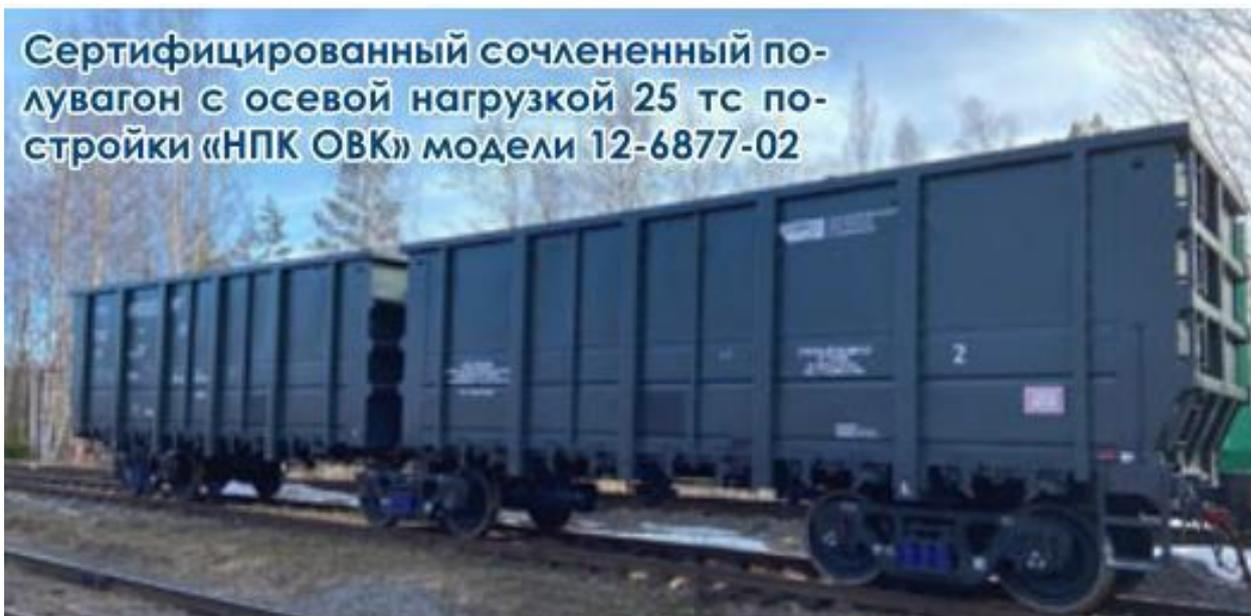
Кроме того, сочлененные полувагоны сокращают потребный парк и удельную стоимость перевозки груза. Конструкция таких полувагонов позволяет проводить выгрузку на вагоноопрокидывателях и/или через разгрузочные люки. Отечественными производителями вагонных весов разработаны устройства, способные взвешивать вагоны сочлененного типа как с расцепкой, так и без нее.
