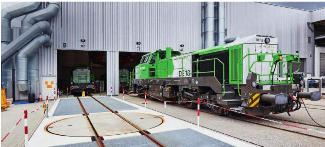
Важным событием стало появление версии SmartHybrid локомотива DE 18, отличающейся наличием тяговых аккумуляторных батарей.
