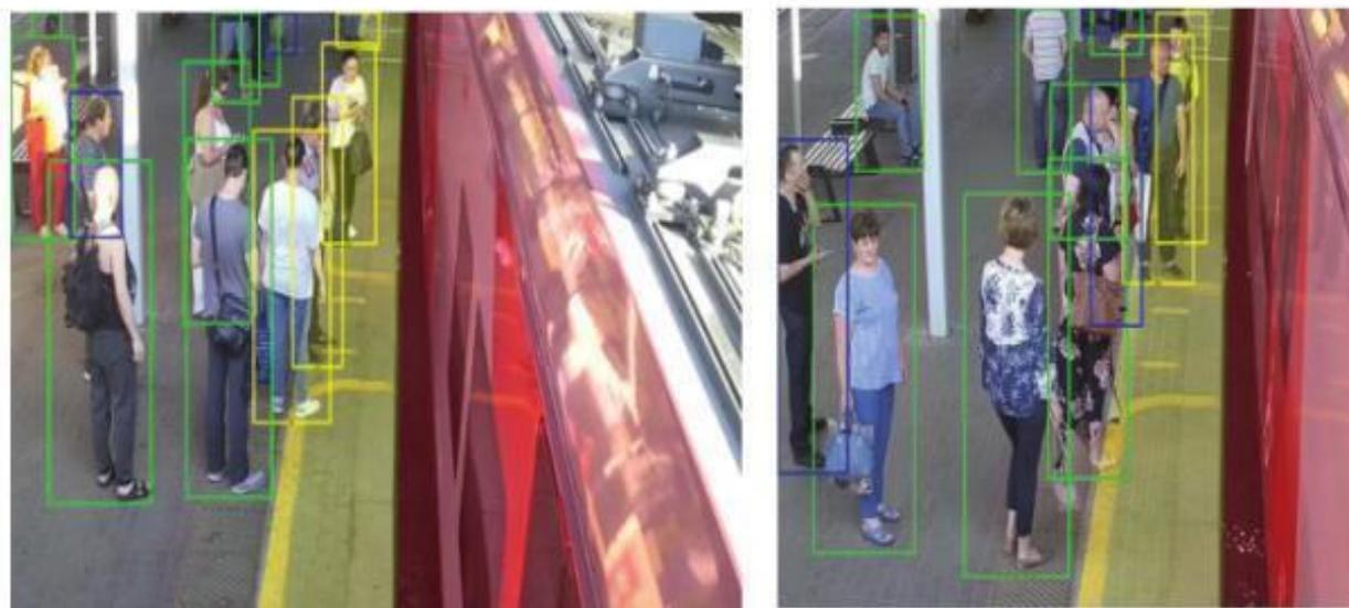
Система контроля посадки и высадки пассажиров в работе
