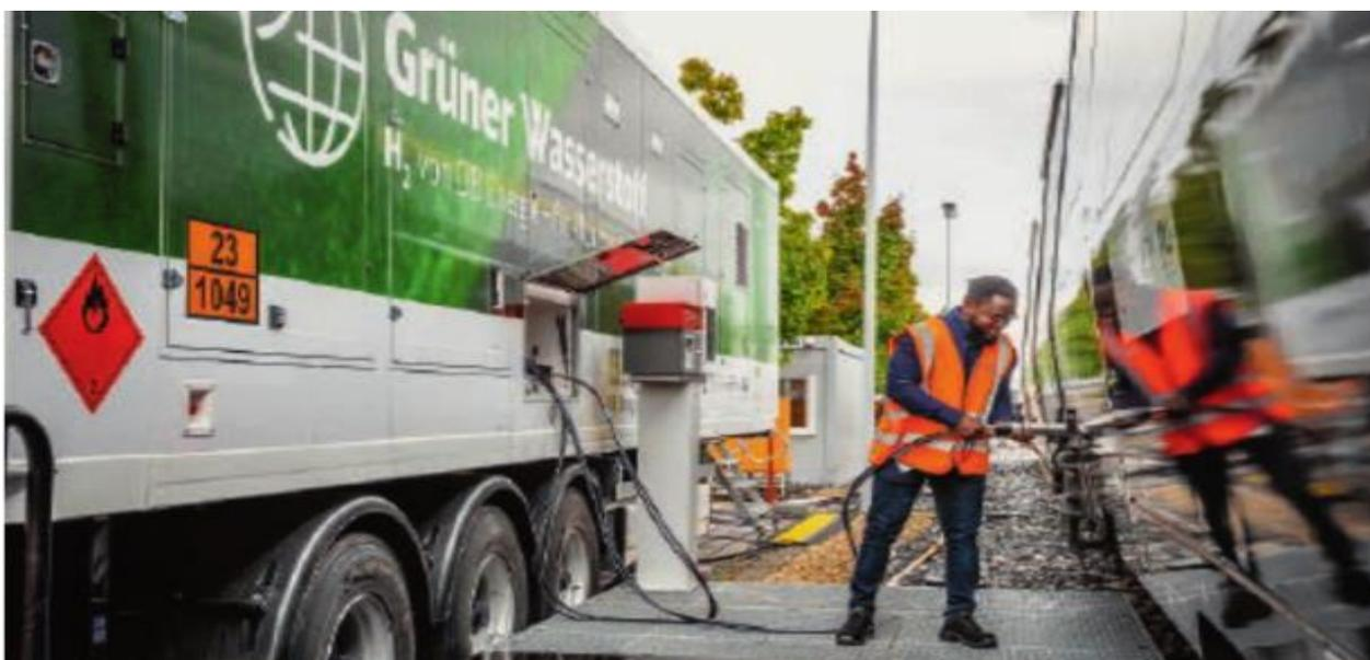
Мобильный пункт заправки поезда водородом, разработанный DB
