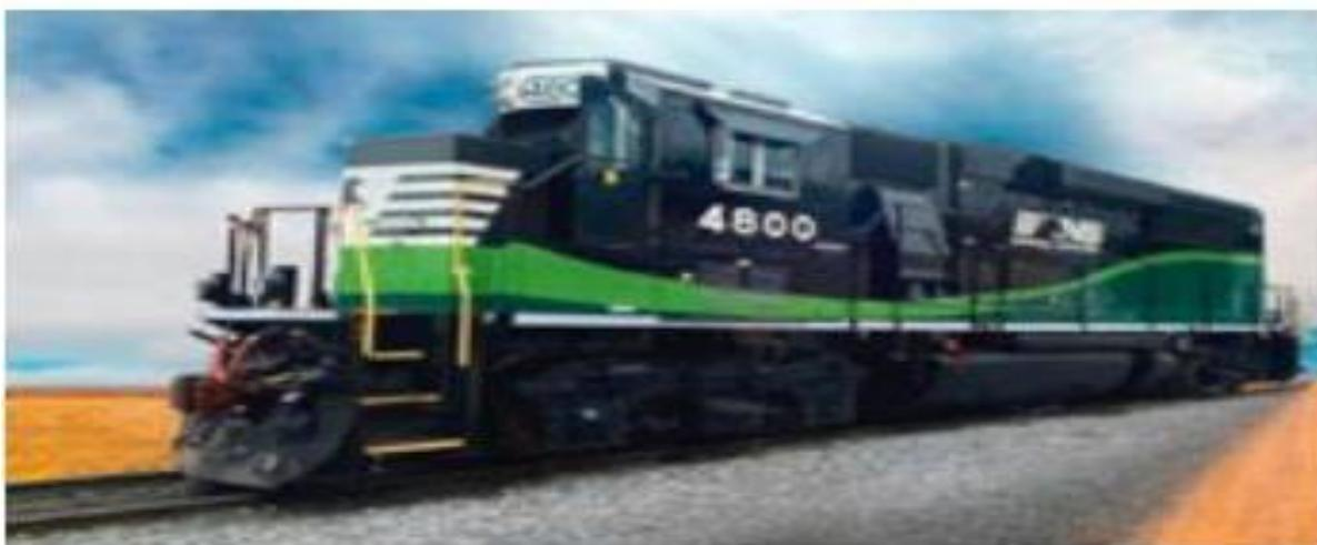
Маневрово-вывозной тепловоз GP34ECO производства компании Progress Rail для железной дороги Norfolk Southern
