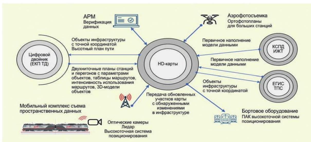
Концепция автоматического создания и обновления высокоточных электронных карт
