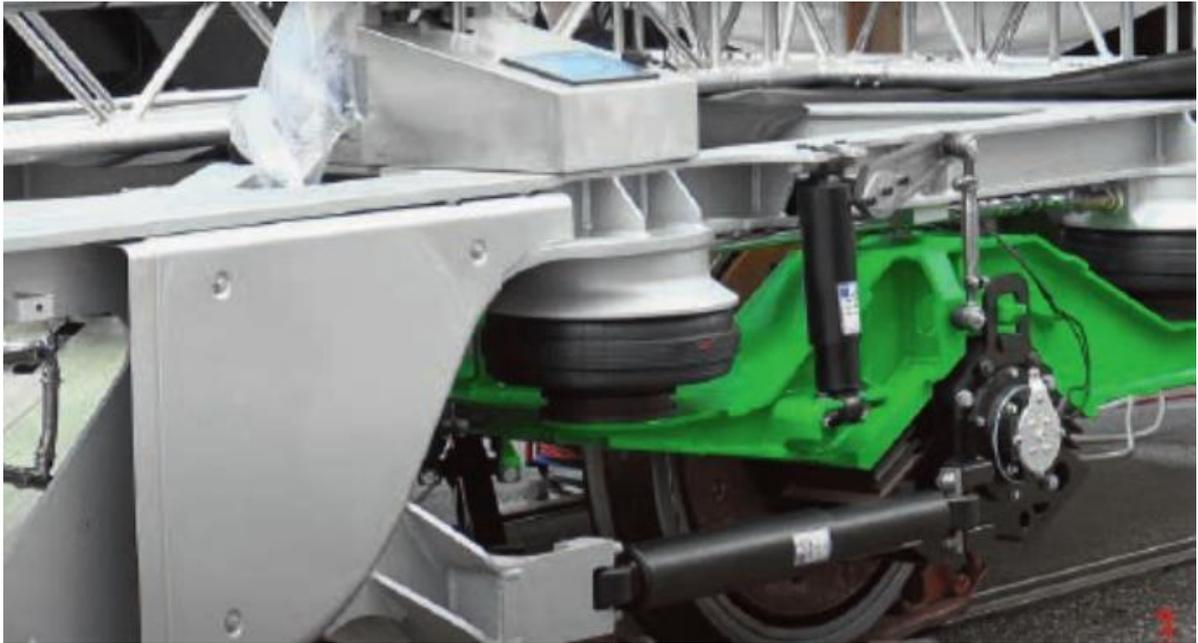
Одноосная тележка облегченного грузового вагона CFW
