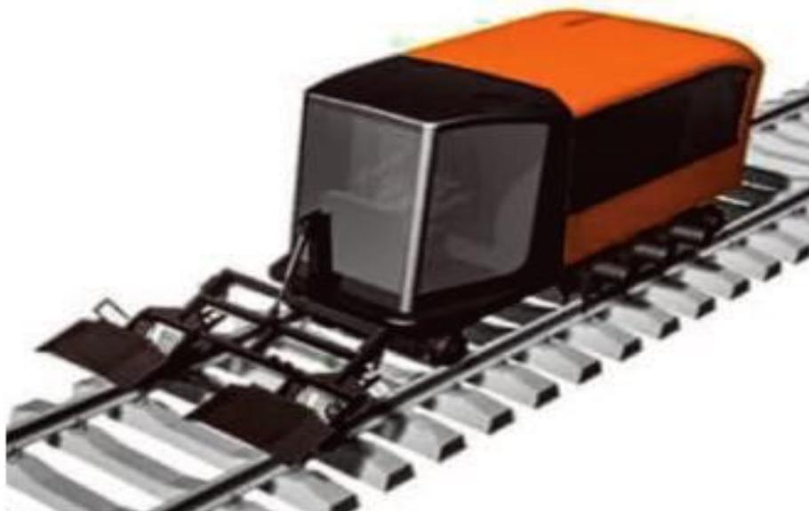
Модель модуля монтажа-демонтажа рельсовых скреплений проекта СТМ
