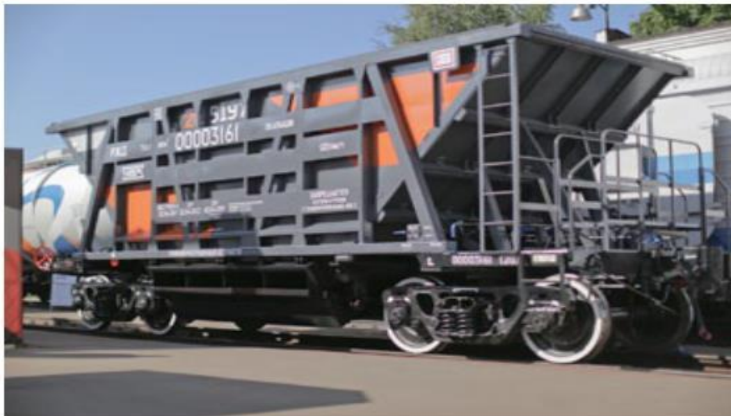
Специализированный вагон-хоппер модели 20-5197 для перевозки окатышей и агломерата с температурой до +400 °С
