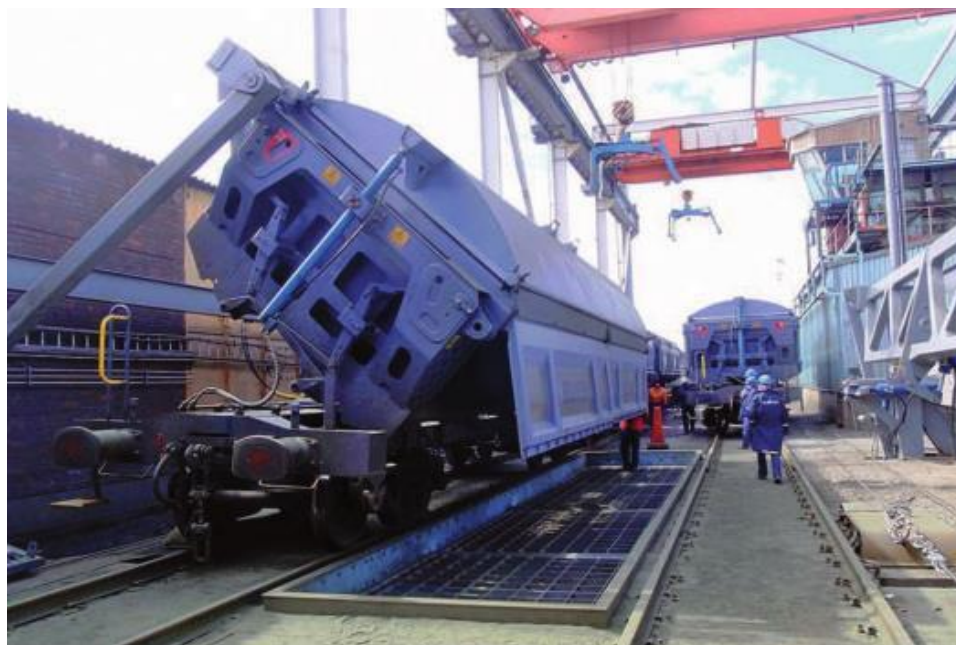
Стационарное устройство для опрокидывания кузова Side Dumper компании Kiruna Wagon
