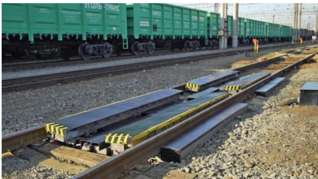
Балочное рычажное закрепляющее устройство ЗУБР
