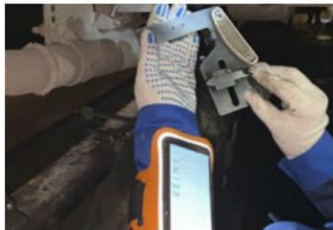
Пример использования «ТУ-18Э» при проведении замеров
