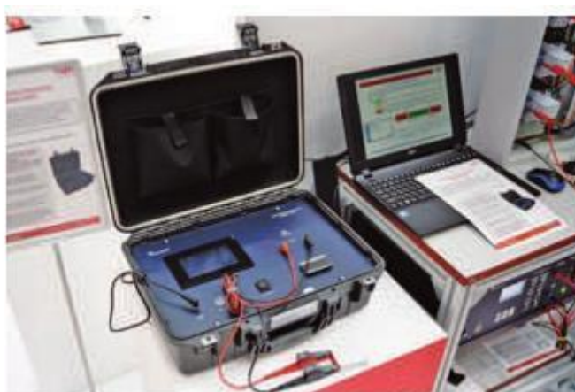
Испытательный генератор «ПРОРЫВ УЗИП»
