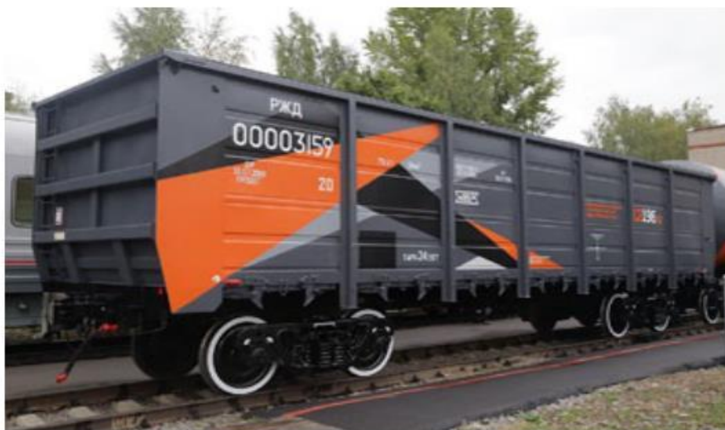
Инновационный четырехосный универсальный полувагон модели 12-196-02
