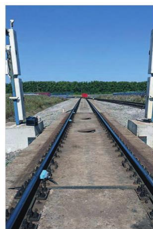
Датчик eDKT на вагонных весах, ООО «Кроношпан Башкортостан»
