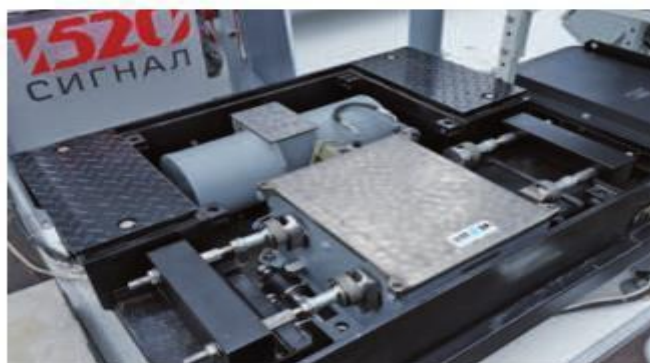
Электромагнитный трамвайный привод ЭМПТ-31К – часть системы АСКУ ДВТ
