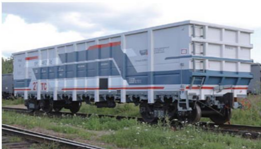
Тяжеловесный вагон с максимальной статической осевой нагрузкой не менее 25 тс
