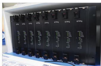
Контроллер тональных рельсовых цепей КТРЦ системы АБТЦ-И
