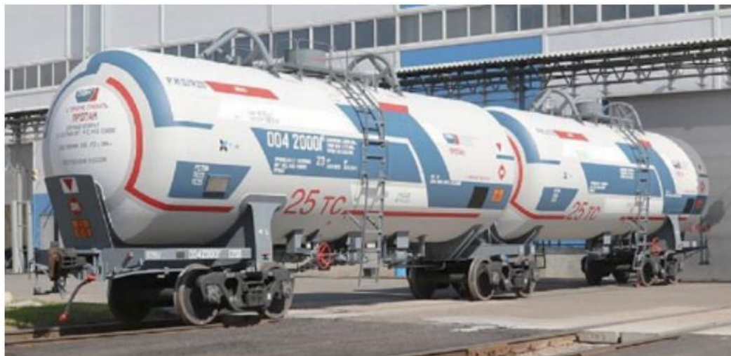
Вагон цистерна модели 15-9541-01 для сжиженных углеводородных газов
