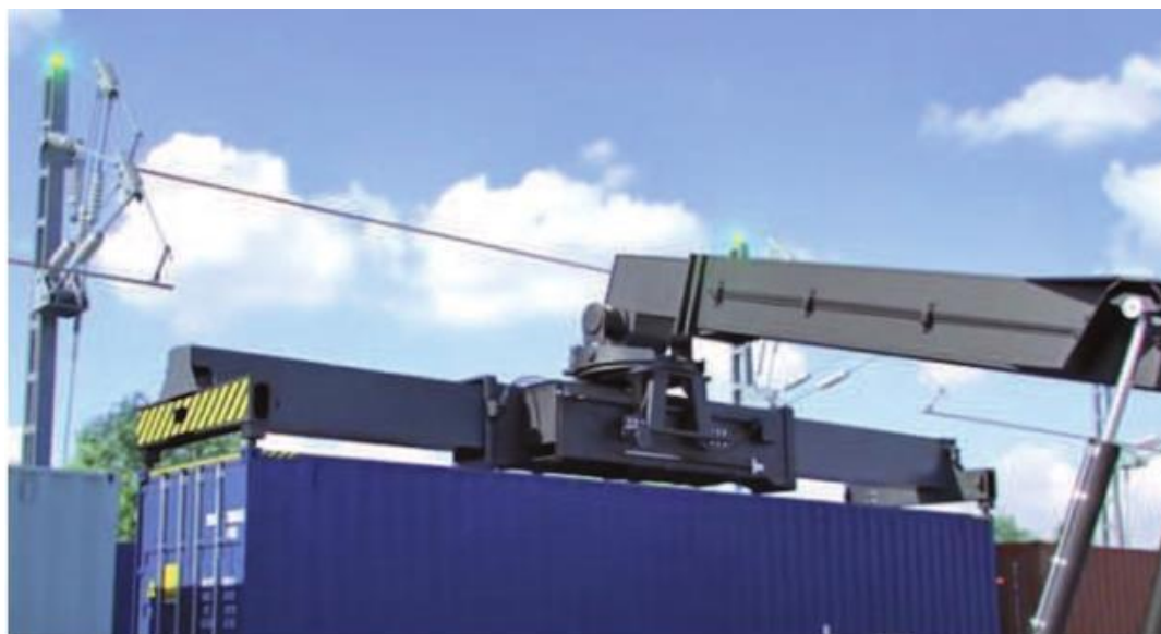
Обработка ричстакером фитинговой платформы с контейнером под отведенным сегментом контактной подвески
