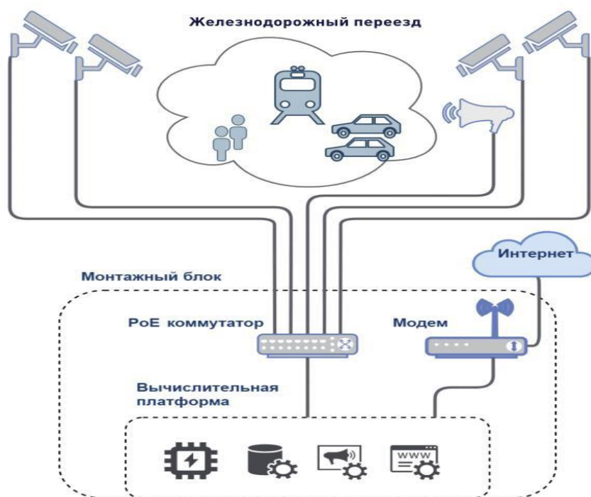
Структурная схема ПТК «Переезд»
