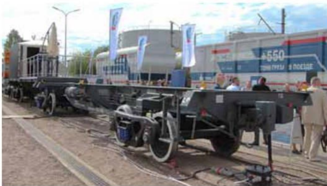
Платформа сочлененного типа модели 13-6741 для контейнеров – уникальный вагон в продуктовой линейке «НПК ОВК» грузоподъемностью 122 т
