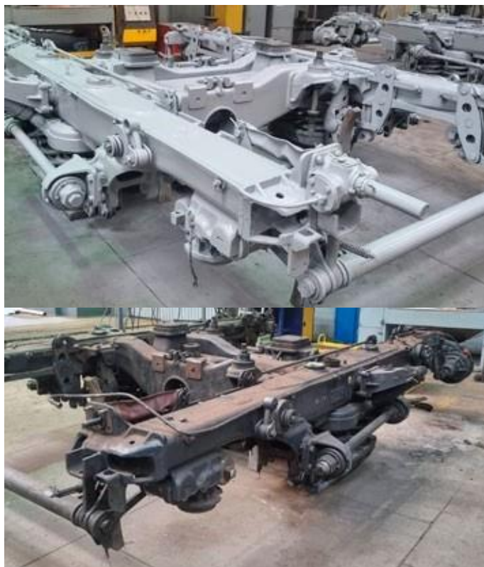
Сравнение экипажной части электропоезда, не обработанной и обработанной антиобледенительным покрытием «ФОРС»
