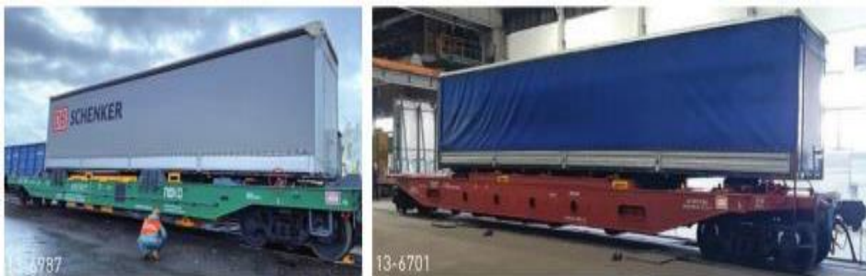
Вагоны-платформы с пониженным уровнем пола в межтележечном пространстве
