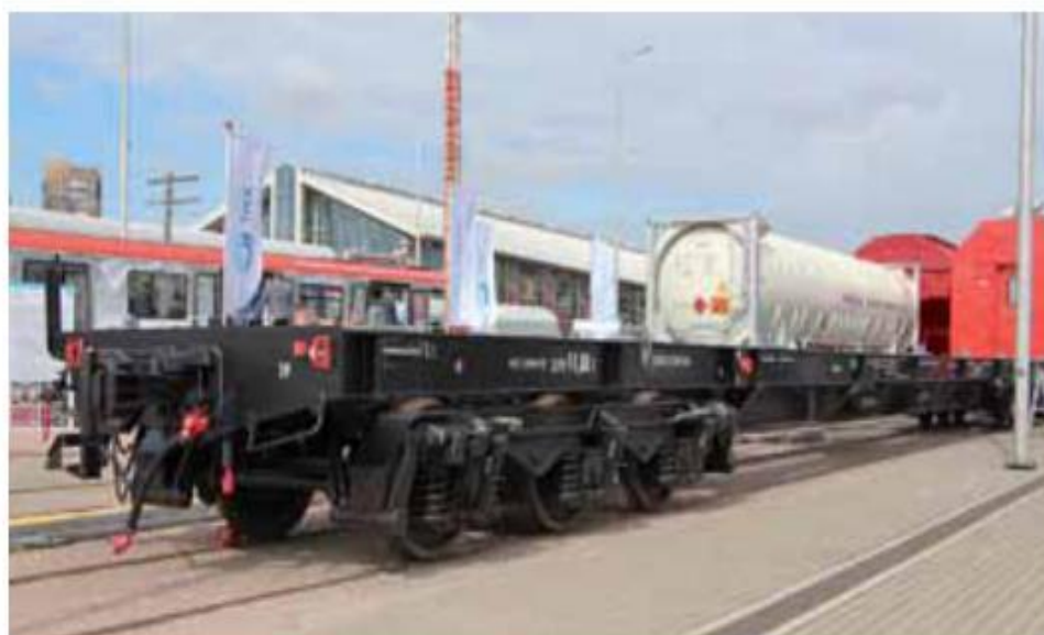
Платформа 13-6704 для контейнеров позволит перевозить грузы со скоростями до 140 км/ч
