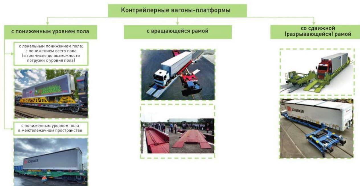
Особенности конструктивного исполнения контейнерных вагонов-платформ
