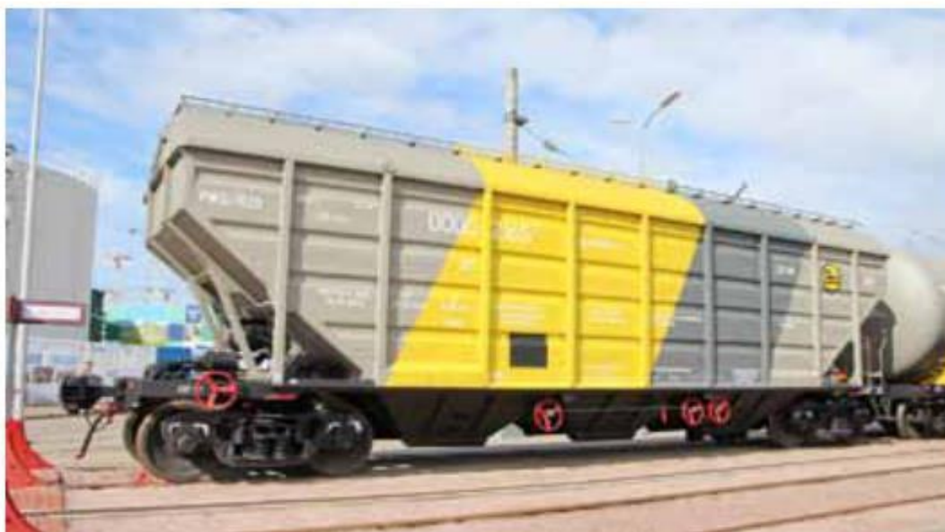
Вагон-хоппер модели 19-2165 для безтарной перевозки зерна постройки АО «Алтайвагон»
