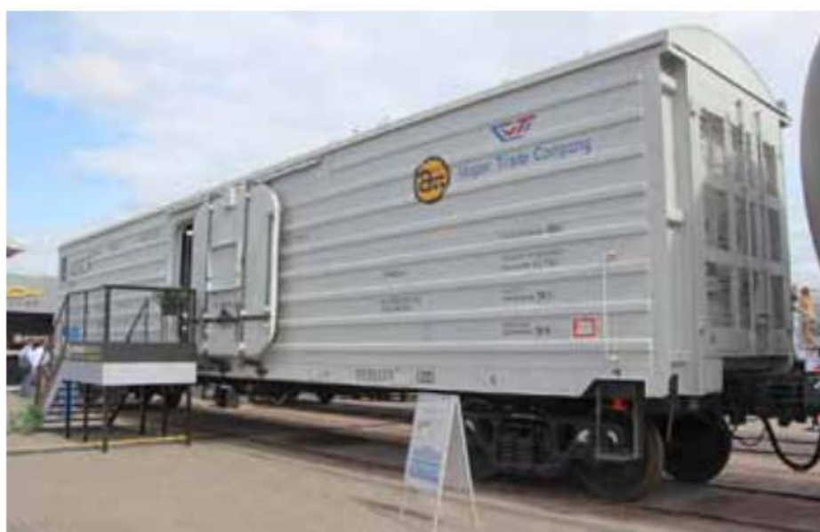
Автономный рефрижераторный вагон модели 16-2155 для перевозки скоропортящихся грузов разработки ОА «Алтайвагон»
